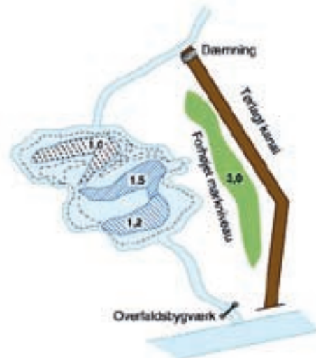
Figur 2. Eksempel på konstrueret vådområde etableret ved at omdirigere afvandingskanal (6).
