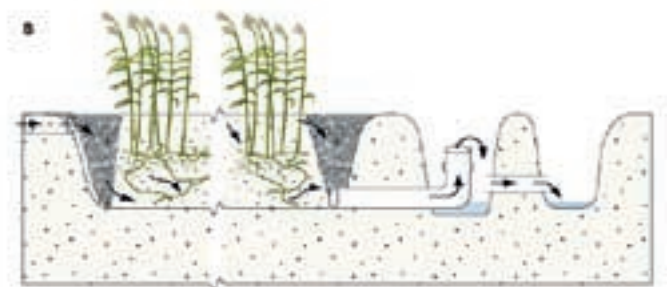
Figur 4. Principskitse af konstrueret vådområde med horisontal gennemstrømning i det porøse sediment der er optimeret med hensyn til fosforbinding (6).
